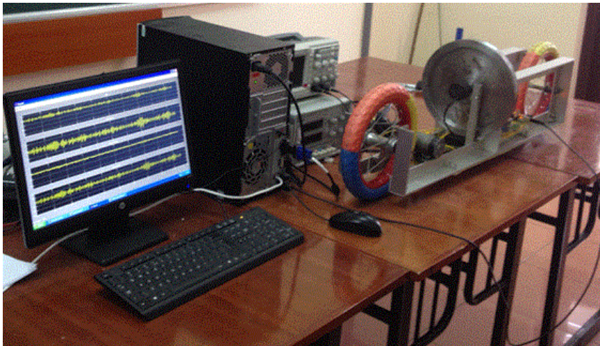
Hình 4.16. Sơ đồ bàn thực nghiệm điều khiển xe hai bánh tự cân bằng
