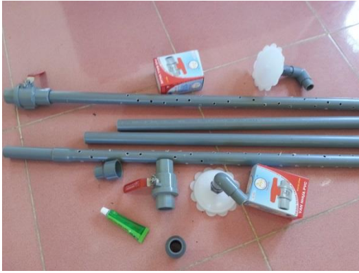
Bộ van, ống bể nước
