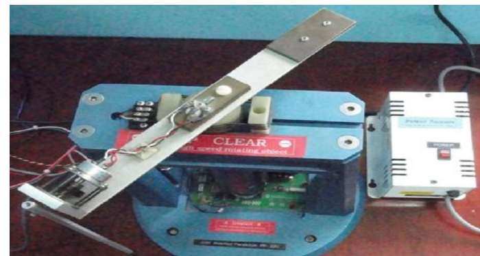
Hình 3.7: Mô hình thí nghiệm con lắc ngược quay Kri PP-300 tại Phòng thí nghiệm Đo lường – Điều khiển, Trường ĐH KTCN Thái Nguyên
