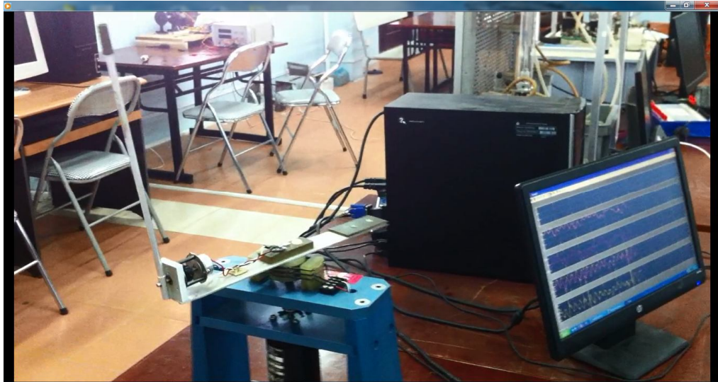
Hình 3.40: Hình ảnh tại bàn thí nghiệm khi điều khiển con lắc ở vị trí thẳng đứng hướng lên trên (góc con lắc bám theo giá trị 0) bằng bộ điều khiển dự báo phản hồi đầu ra theo Thuật toán 2.7
